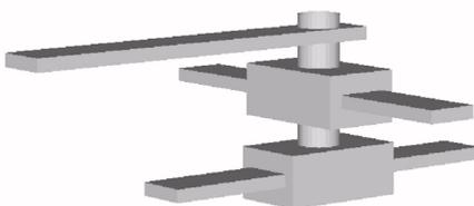
Fig. 3 : Principe d'un montage de 3 barres, 2 glissières pour 2 des 3 barres et une articulation axiale commune.
