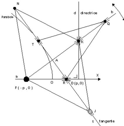
Soit une barre  $a$ , alignée sur  $Ox$ ; sur cette barre, un pivot au foyer  $F$  de la parabole. Une barre  $d$  matérialise la directrice de cette parabole.
